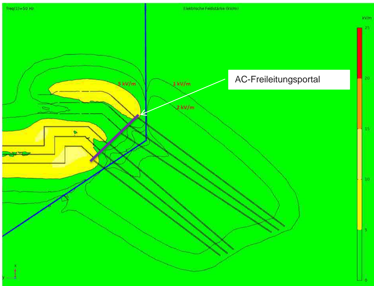
Abbildung 9: Elektrisches AC-Feld in 1 m Höhe im Bereich zwischen AC-Freileitungsportal auf Konvertergelände und dem ersten AC-Freileitungsmast
