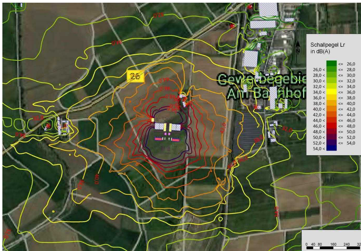
Abbildung 4: Isophonienlinienkarte für die Konverterstation Bergheinfeld/West, die gleichen Bedingungen wie in Abb. 3, aber nähere Ansicht und höhere Isophonaufösung (2 dBA).
